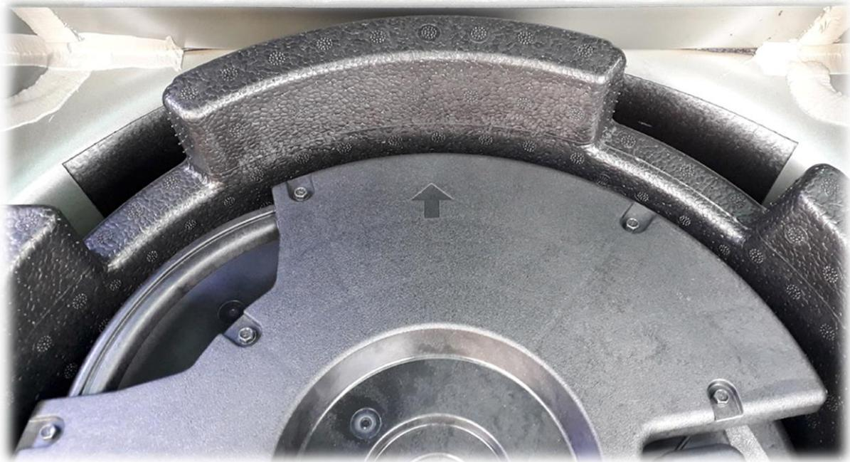
Die Seitenverkleidung dabei am unteren Rand anheben und die Styroporkörper hervorziehen. Mit etwas Gefühl ran gehen, damit nichts abbricht.
