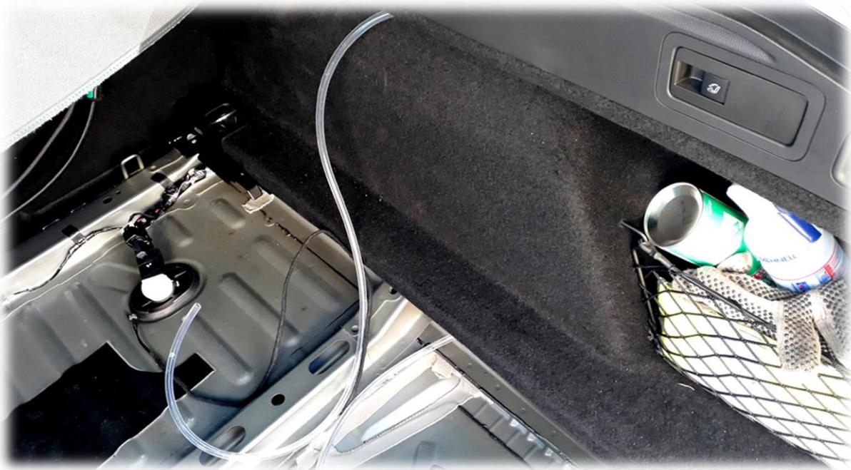
Das rechte Kabel nun an der Verstärkung entlang mit selbstklebenden Kabelhaltern befestigen und zur Vorbereiteten Schnittstelle an der original Kofferraumbeleuchtung ziehen und verbinden.
