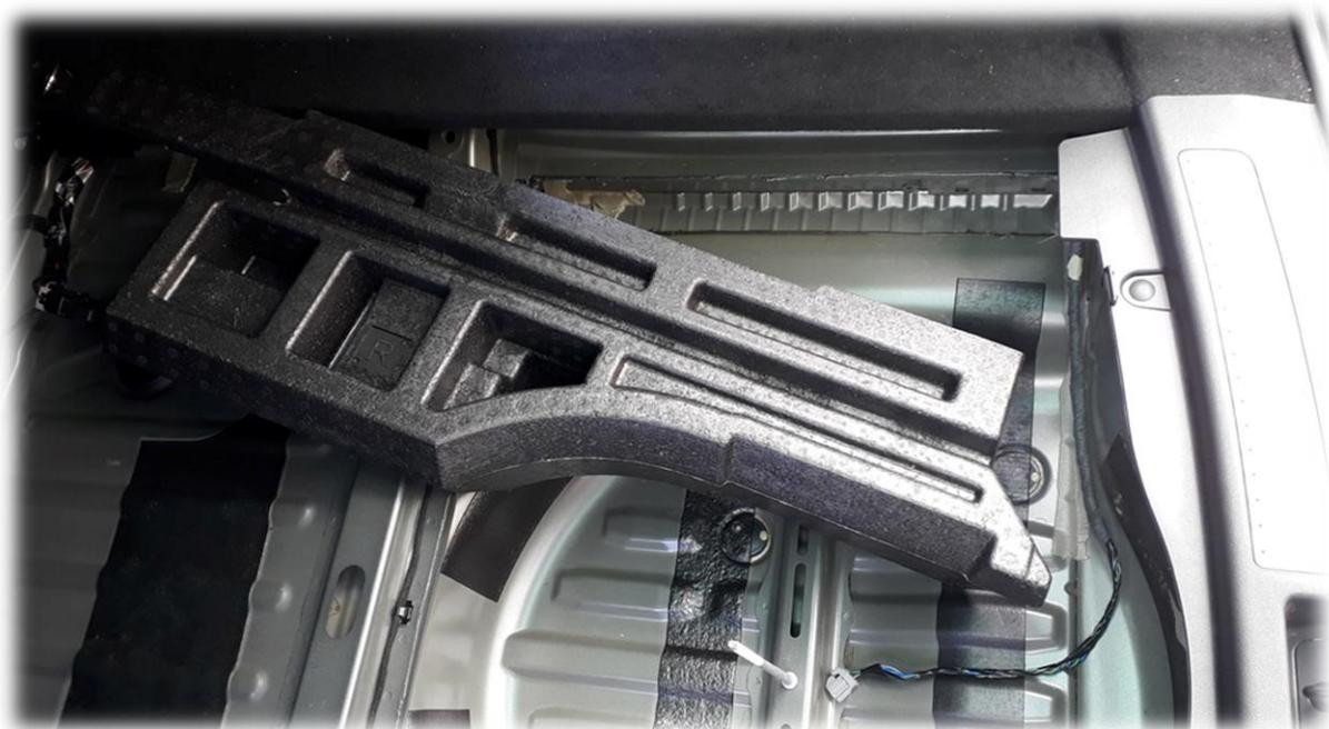
Zum durch fädeln der Kabel ist eine Einziehhilfe von Vorteil, welche ich nicht hatte. Es ging aber auch mit einem Benzinschlauch ganz gut. Von oben durch die Belüftungsschlitze nach unten ziehen, wobei die linke Seite wegen der Serviceklappe besser geht.
